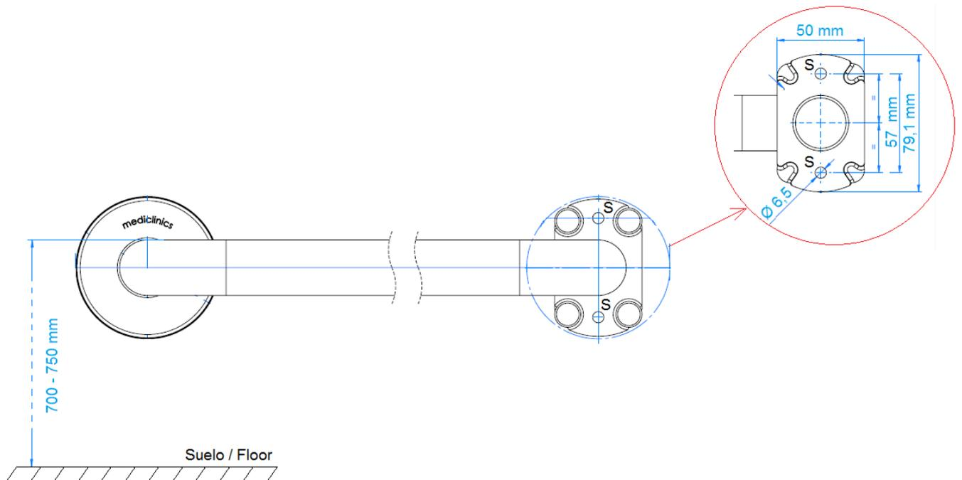
Se recomienda montar la barra entre los **700 y los 750 mm** de altura, respecto al suelo, tal y como se indica en el apartado "Barras de apoyo", "Sección SUA 9, Accesibilidad" del "Documento Básico SUA Seguridad de utilización y accesibilidad".
