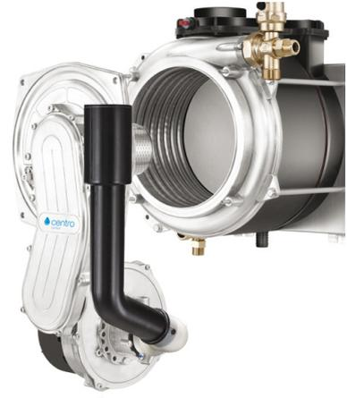
Nuevo intercambiador tubular **COMBITECH**, fabricado íntegramente en acero inoxidable que genera un alto rendimiento térmico. Gracias a su gran sección de paso de agua (28mm), proporciona unos bajos costos en su mantenimiento junto a una pérdida de carga mínima, que con su bomba de circulación modulante, facilita y adapta perfectamente el reparto de calor en todo el sistema de calefacción.
